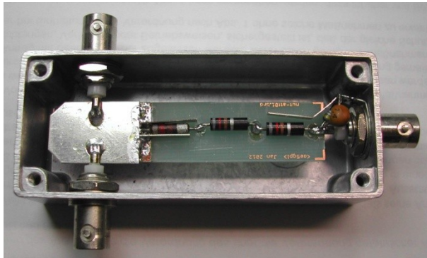
Abb. 14: Aufbau mit Kohle-Massewiderständen
