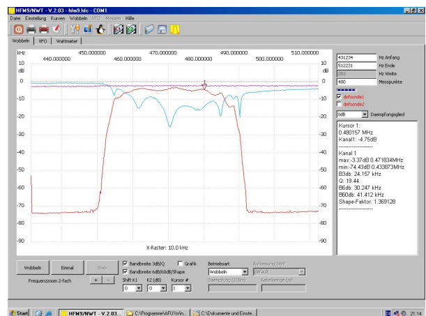
Abb. 12: 470-kHz-Keramikfilter von MURATA (CFR470C). Beste Anpassung bei Stufe 800 Ohm, die Trimmer haben keinen erkennbaren Einfluß auf die Durchlaßkurve
