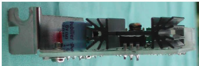
Abb. 1: Montage des LM317
